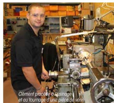
Clément procède à l'usinage et au tournage d'une pièce de vérin
