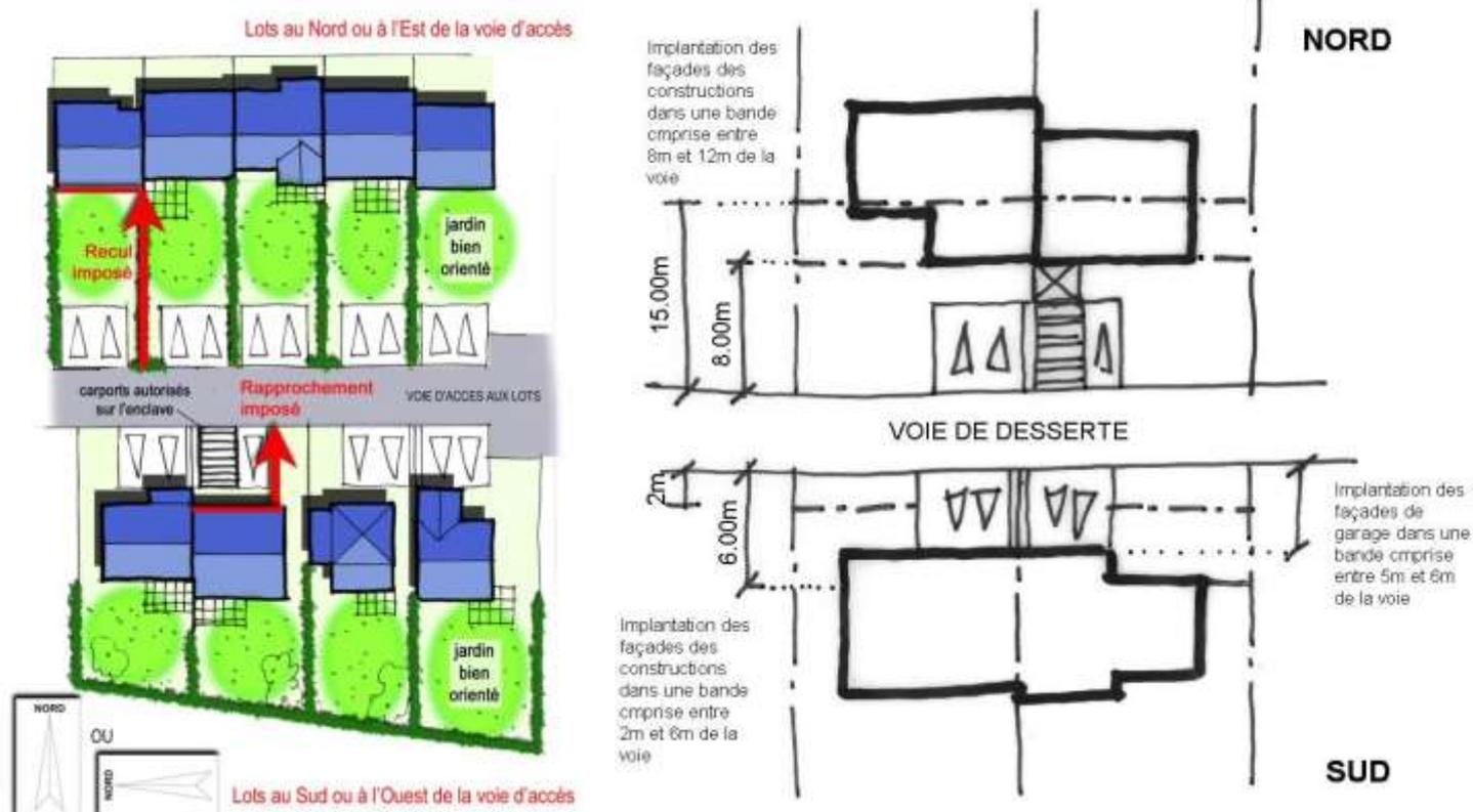
P- Pour l'ensemble des constructions, on cherchera à maximiser l'ensoleillement selon le schéma de principe ci-contre.
