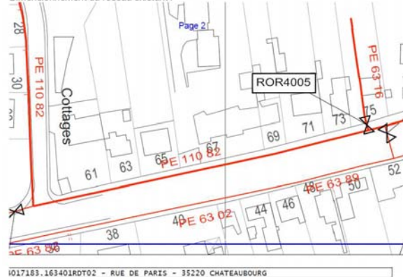
Figure 2: Réseau de gaz existant sur le site de gendarmerie - localisation et dimensions
