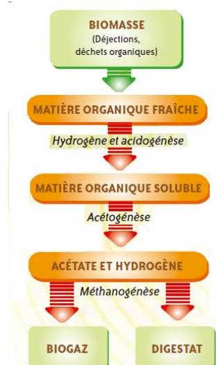
Figure 1 : Réactions du processus de méthanisation
